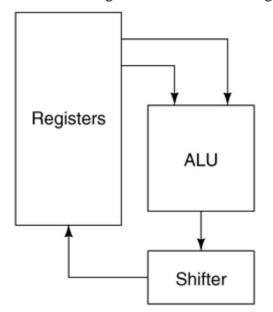
Unser Computer besteht aus einer ALU, einer Arithmetisch logischen Einheit, einigen Registern und Schieberegister.
